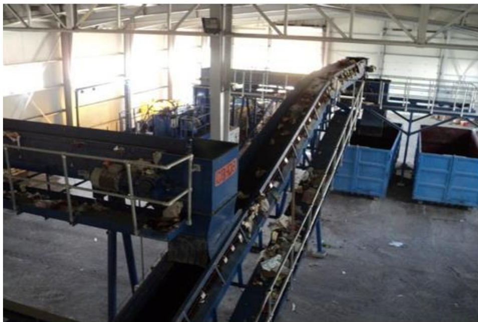
Slika 25. Sortirna stanica u okviru pogona Regionalnog reciklažnog centra na deponiji Livade u Podgorici [57]
