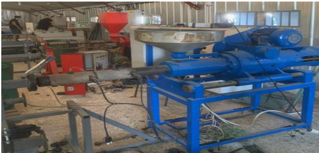
Slika 37. Izgled ekstrudera koji se koristi za topljenje plastičnog granulata [69]
