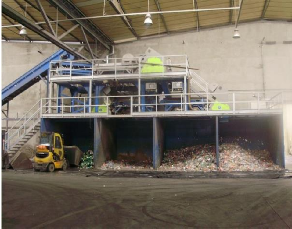
Slika 23. Optička sortirnica u okviru postrojenja kompanije „Drava International” [53]
